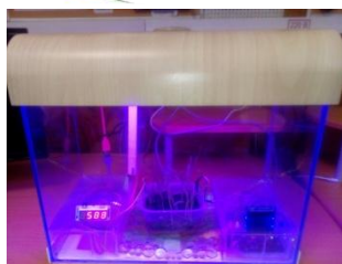
Рис. 2. Использование светодиодной ленты с RGB подсветкой позволяет моделировать свет различных оттенков и изучать его влияние на рост растений
