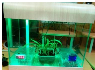
Рис. 2. Использование светодиодной ленты с RGB подсветкой позволяет моделировать свет различных оттенков и изучать его влияние на рост растений
