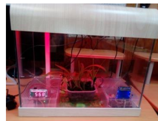
Рис. 2. Использование светодиодной ленты с RGB подсветкой позволяет моделировать свет различных оттенков и изучать его влияние на рост растений
