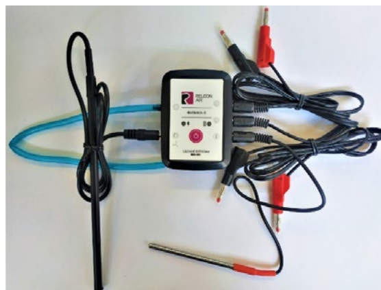
Рис. 9. Беспроводной мультидатчик Releon Air «Физика-5»
